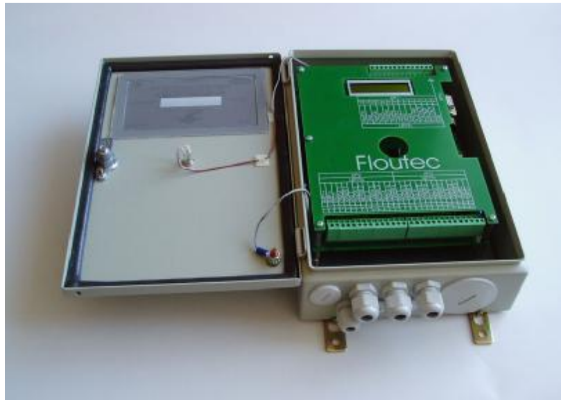
Рис. А.1 - Обчислювач VR комплексу «ФЛОУТЕК-ТМ» з відкритою кришкою і присутньою фальш-панеллю
